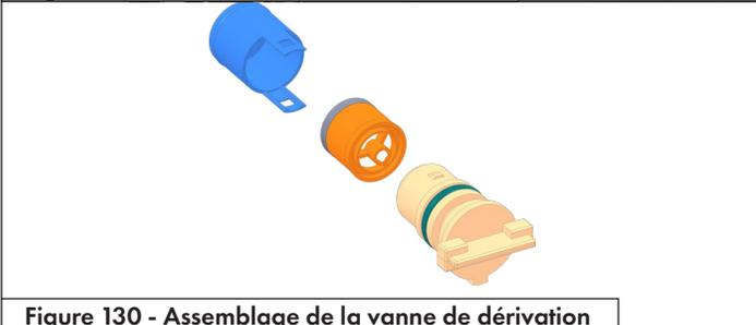
Figure 130 - Assemblage de la vanne de dérivation
