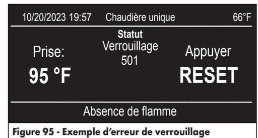
Le bouton RÉINITIALISATION (RESET) doit être actionné sur le panneau de commande pour rétablir le fonctionnement de la chaudière.
