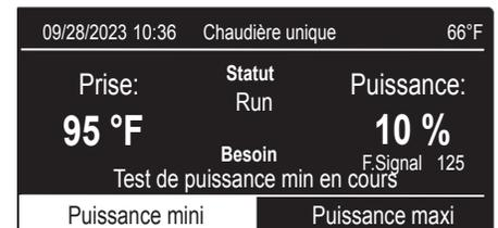
**Réglage de la vanne de gaz à puissance minimale (10 %)**
