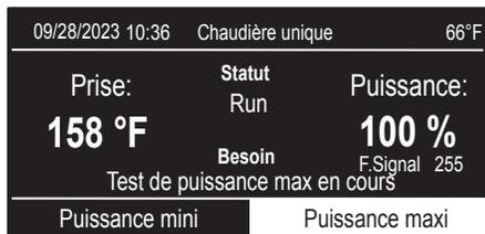
Tournez le cadran pour sélectionner la puissance MINIMALE et appuyez sur ENTRÉE. La chaudière se module à la puissance minimale (10 %).
