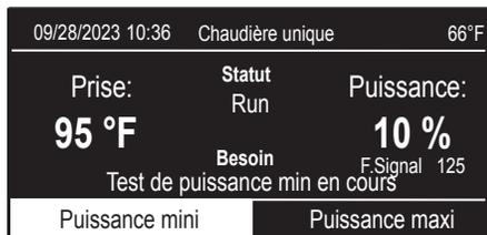
Réglez la combustion conformément au tableau 43. Appuyez sur ÉCHAP (ESC) pour interrompre le test.
