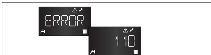
Figure 10 - Exemple d'erreur de blocage
