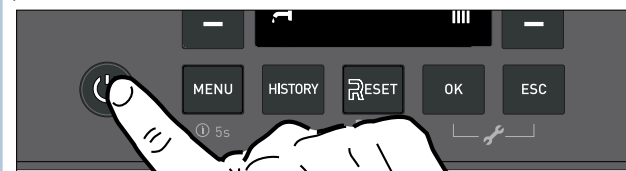
Figure 2 - Mise sous tension de la chaudière
