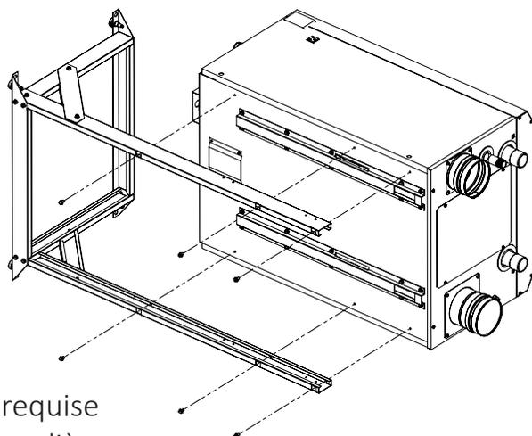
**Note:** Une cale peut être requise en dessous de la chaudière pour aligner les trous de vis.
