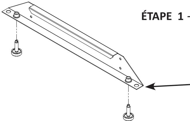
**ÉTAPE 1** — Placer les pattes au niveau en utilisant les pieds ajustables.
